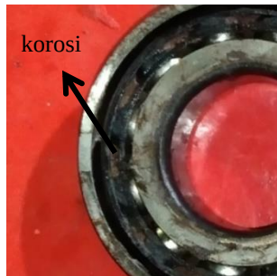
Gambar 6. Korosi akibat air masuk
