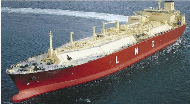
Figure 2: Membrane type LNG carrier
