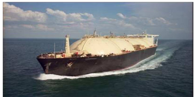
Figure 1: Moss or spherical LNG carrier
