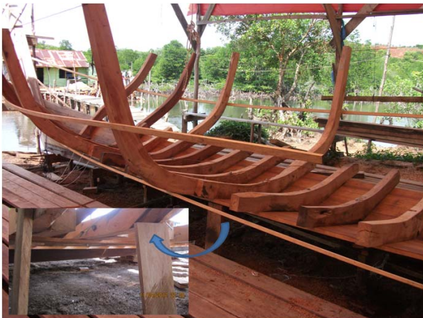
Figure.8. Longitudinal main stiffener
